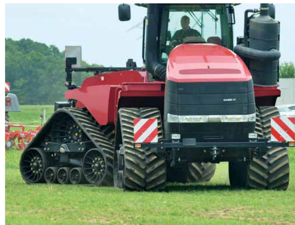
Den Boden schonen: Schlepper mit Gleiskettenlaufwerk
