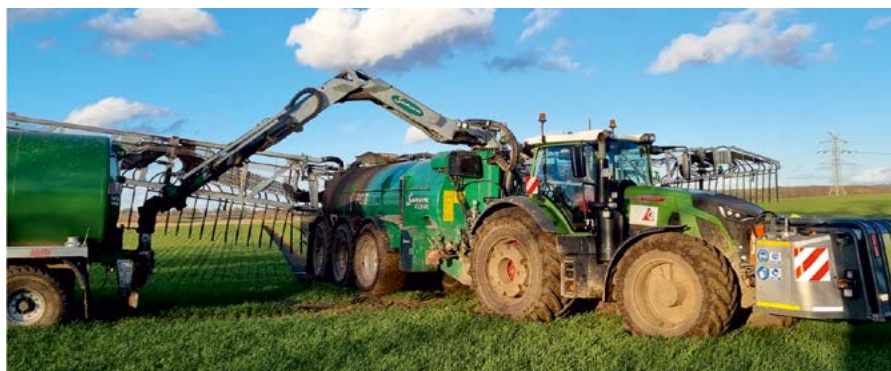
Gülle wird am Feldrand nachgeladen – das Fass ist mit Nah-Infrarot-Sensoren (NIRS) ausgestattet und kann so konstante Nährstoffmengen ausbringen.
