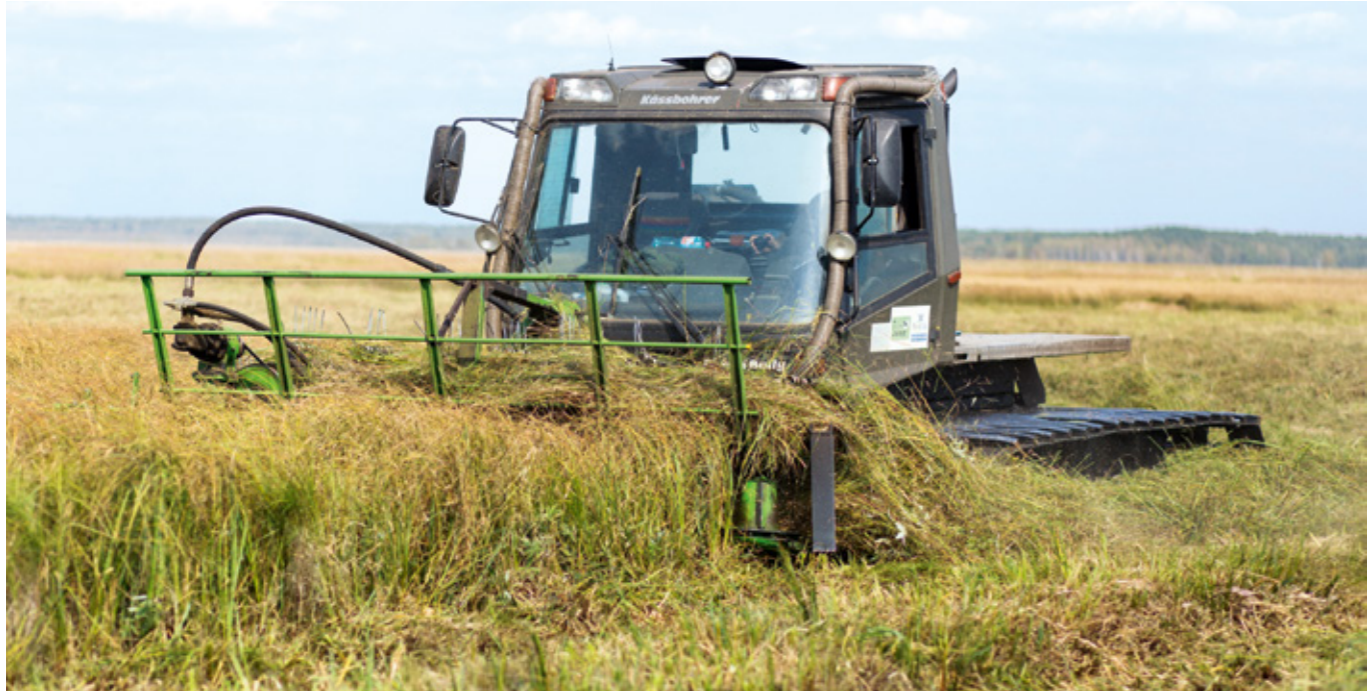
Auch nasses Moor kann bewirtschaftet werden: Mahd von Nasswiesen-Biomasse mit angepasster Technik
