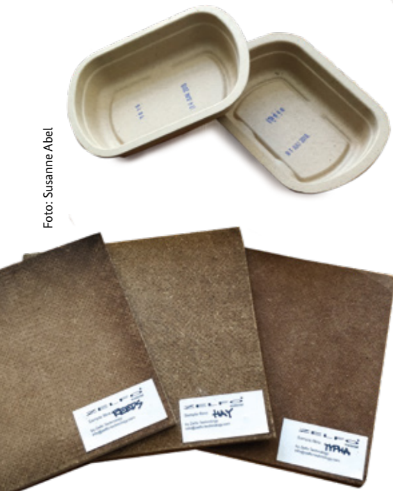
Stoffliche Verwertungsmöglichkeiten für Moorbiomasse: Bauplatten und Einwegschalen
